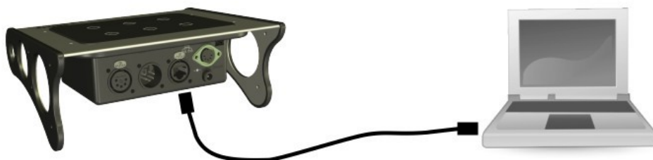
Figura 1: Connessione diretta al computer con cavo cross
