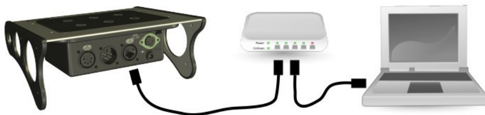
Figura 2: Connessione al computer attraverso HUB con cavo patch
